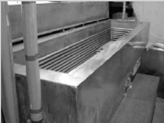
手動3槽式洗浄装置
