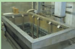
手動3槽式洗浄装置
